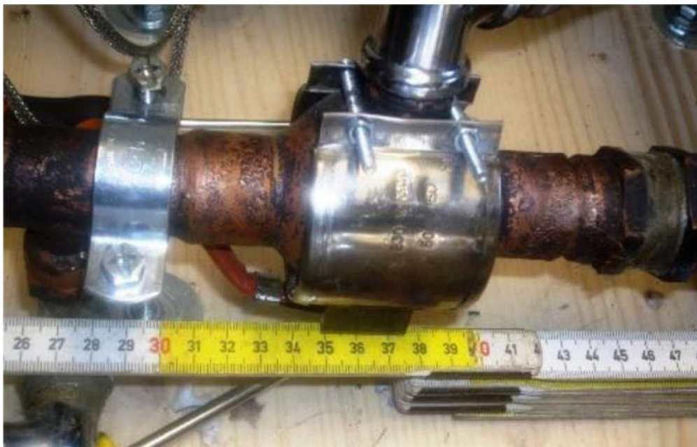
Figura 3: Mostra o recipiente de combustível central, entre os 35 e 40 centímetros na régua. É de cerca de 50 cm 3 de volume. (Foto: Giuseppe Levi).
