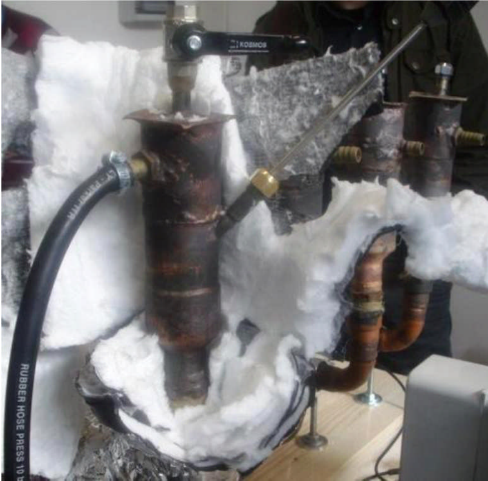
Figura 4: Mostra a chaminé com a tubulação de saída preta, o suporte do termopar e no topo, a válvula de escape de vapor. (Foto: Giuseppe Levi).
