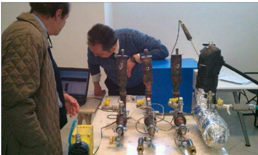
Figura 1 mostra Andrea Rossi (à esquerda) e Giuseppe Levi (direita). São mostrados a bomba de água em amarelo, três dispositivos Rossi (ECATS) nus e um dispositivo isolado termicamente, que foi utilizado para o experimento.
